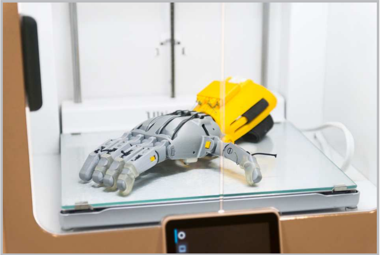
Görsel 1.34: 3 boyutlu yazıcıyla üretilmiş bir robot el modeli
