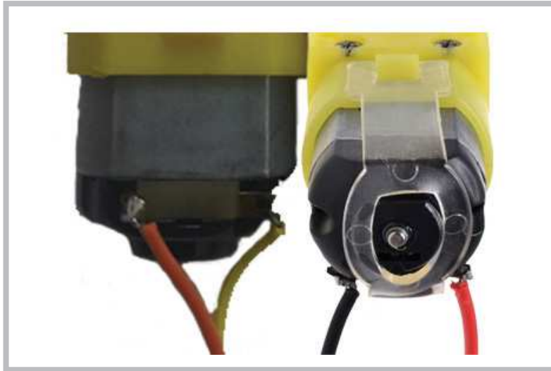
Görsel 3.13: Eğitsel robotun motor uçlarının lehimlenmesi
