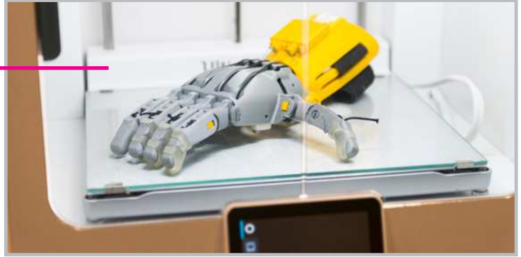
Görsel 1.34: 3 boyutlu yazıcıyla üretilmiş bir robot el modeli
